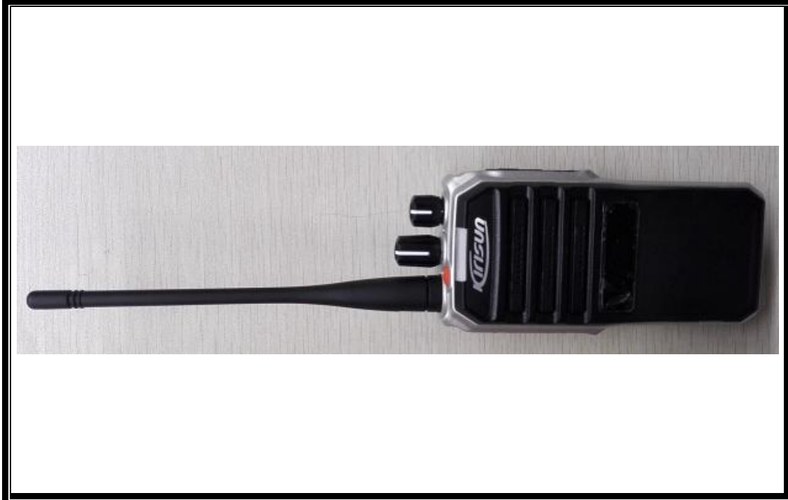
整体照 物理尺寸：长 X 宽 X 高=265mm (L) X60mm (W) X33mm (H)
