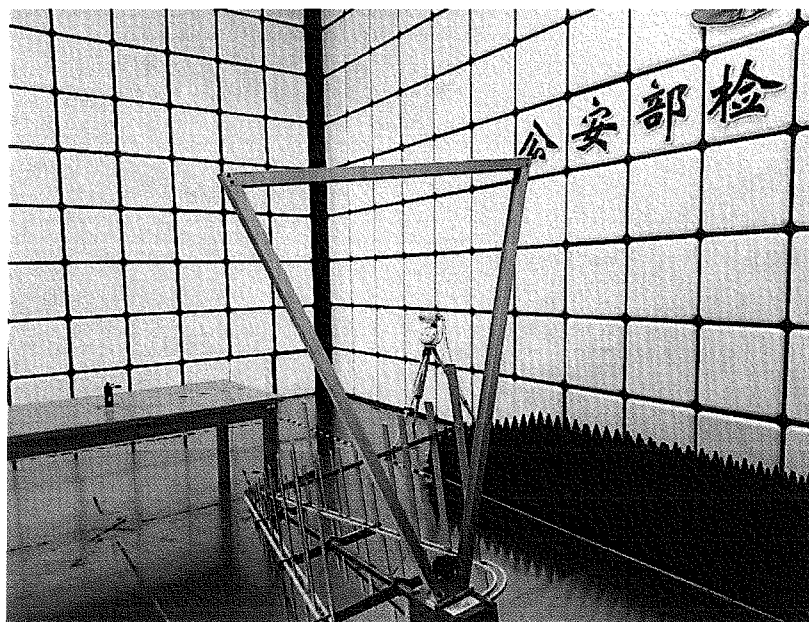
图七：辐射骚扰检测布置图（30MHz-1000MHz）
