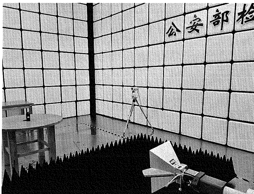
图九：辐射骚扰检测布置图（1GHz-6GHz）
